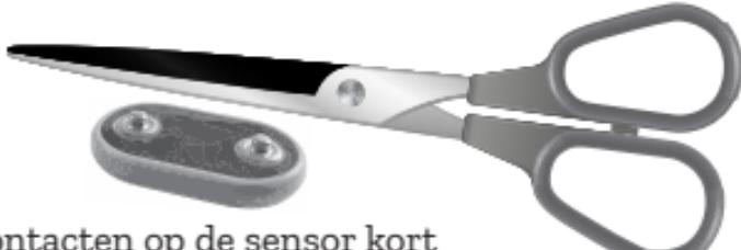
Sluit de contacten op de sensor kort met een metalen voorwerp zoals een schaar.
