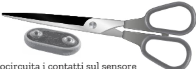
Cortocircuita i contatti sul sensore utilizzando un oggetto metallico come una forbice.
